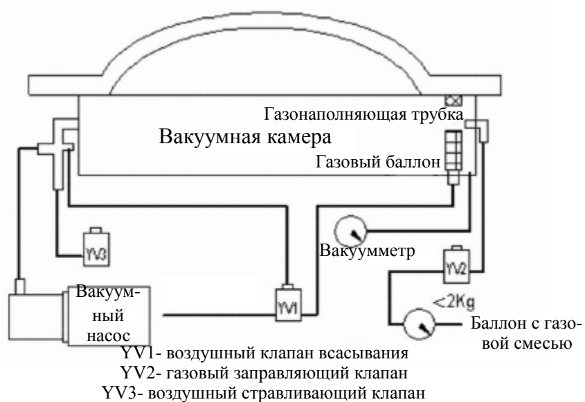
Схема вакуумного упаковщика с системой газации
