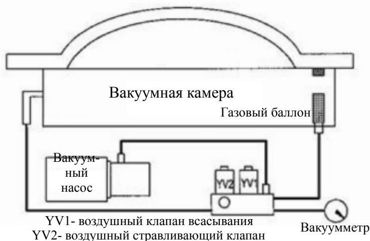
Схема вакуумного упаковщика с производительностью вакуумного насоса 10 м3
