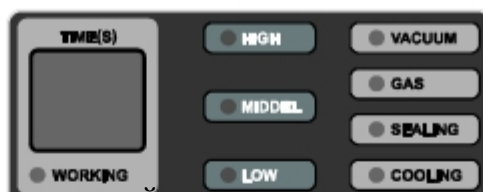
Рисунок 4.3 - Расположение таймера и индикаторов панели управления
