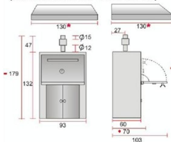
2) Диаметр трубы дымоотвода.
