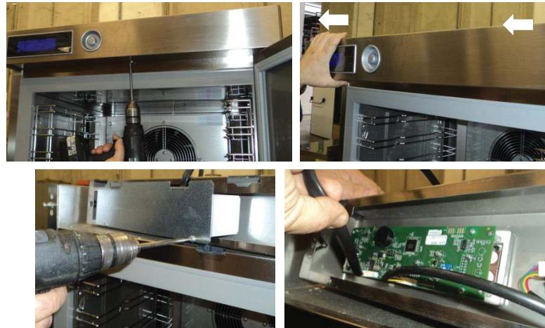
Ослабьте винты и снимите крышку для доступа к видеокарты и датчик
